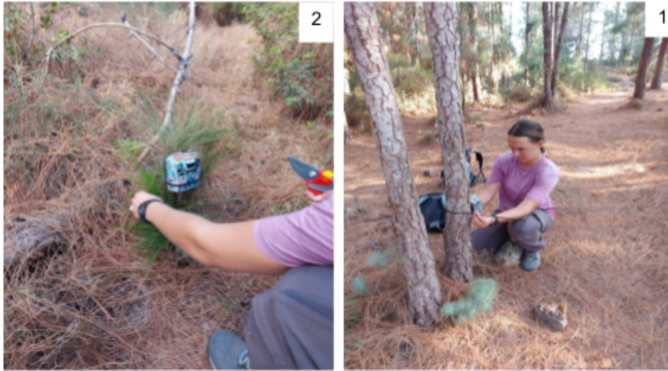
תמונה 1: הצבת מצלמת שביל על עץ בגובה של 45 ס"מ מעל הקרקע, בזווית ישרה וממול לשביל בע"ח. תמונה 2: הצבת מצלמת שביל על גבי יתד בגובה של כ-40 ס"מ מעל הקרקע.
